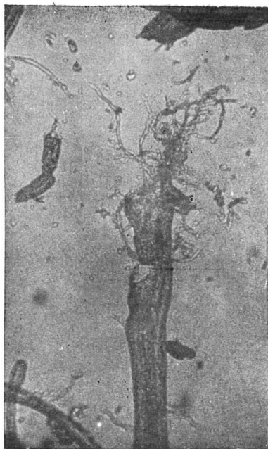
Obr. 8. Sulfitová buničina smrková, mletá na Lampénově mlýně do 65 — 70° Schopper-Riegler. Obvyklé třepení konce tracheidy na fibrily. Zvětšeno 275×. Obr. 9. Sulfitová buničina smrková, mletá na Lampénově mlýně do 65 — 70° Schopper-Riegler. Část rozmáčknuté tracheidy, jejíž lamela u sekundární blány se tlakem rozvinula do plochy a z části ukázala svou fibrilární strukturu. Zvětšeno 275×.
