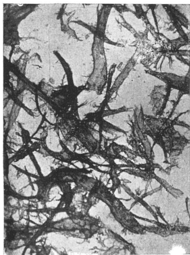
Obr. 6. Sulfitová smrková buničina, na níž bylo po deset minut působeno Schweizerovým činidlem (zředěným v poměru 1:1), a která byla mletá pak 3 hodiny v Lampénově mlýně.
