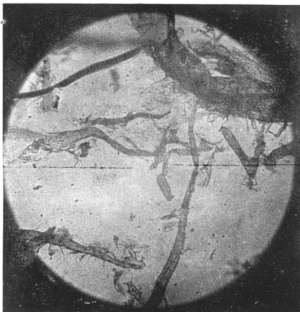
Obr. 10. Topolová buničina mletá na Lampénově mlýně. V pravém rohu nahorě poškozená trachea s natrženou primární blankou, která jako jemný závoj je odchlípená. Zvětšeno 120×.
