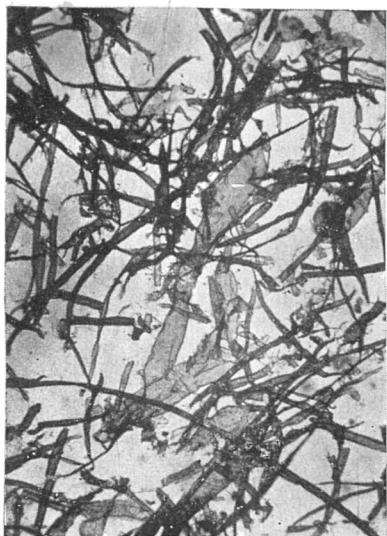
Obr. 4. Topolová buničina, mletá 3 hodiny na Lampénově mlýně při hustotě 3%, 36° SR. Zvětšeno 80×.
