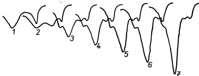
Obr. 4. Vplyv koncentrácie dietylditiokarbamínanu na stanoviteľnosť COS vedľa \text{CS}_2 . Konštantná koncentrácia \text{H}_2\text{S} a COS ako dietylmonotiokarbamínanu ( 3,38 \cdot 10^{-5} M a meniac sa koncentrácia \text{CS}_2 ako dietylditiokarbamínanu: 1. 0; 2. 0,175; 3. 0,353; 4. 0,526; 5. 0,700; 6. 0,872; 7. 1,052 \cdot 10^{-5} M- \text{CS}_2 . Krivky registrované od 9. závitú, SKĽ, 200 mV na abscisu, h = 50 , derivačná polarografia, citlivosť 1 : 3.
