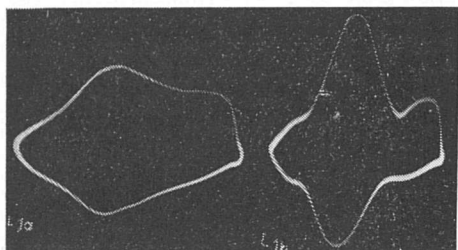
Abb. 1. Die oszillographische Kurve dE/dt = f_1(E) des p -Toluensulphochlorids in Azetat—Methylalkohol Grundlösung. 2 M- \text{CH}_3\text{COOH} und 2 M- \text{CH}_3\text{COONa} mit \text{CH}_3\text{OH} in Verhältnis 4:1 vermischt. a) leere Grundlösung; b) 1 \cdot 10^{-4} M p -Toluensulphochlorid.
